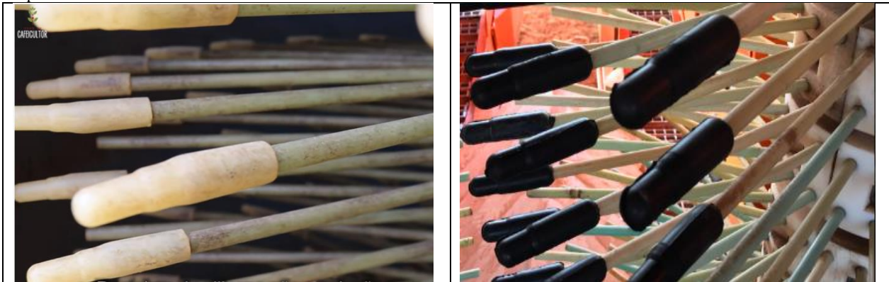
Figura 1 – Pontas de varetas de colhedora protegidas por pontas de silicone ou borracha dura. Elas reduzem danos sobre o tronco e ramos de cafeeiros na colheita de cafeeiros mais novos, especialmente na 1ª safra.
