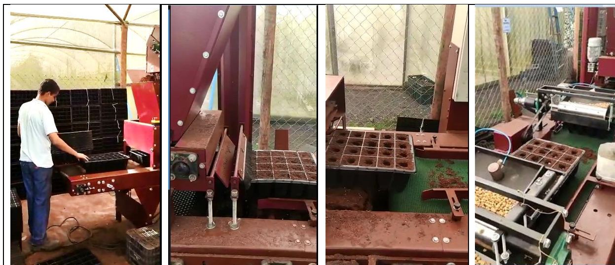
Figura 1- Da esquerda pra direita, sequencia - 1- alimentando a máquina com bandejas vazias, 2- bandeja cheia com substrato, 3- bandeja com orifícios feitos no substrato, e 4- bandeja saindo já com sementes.
