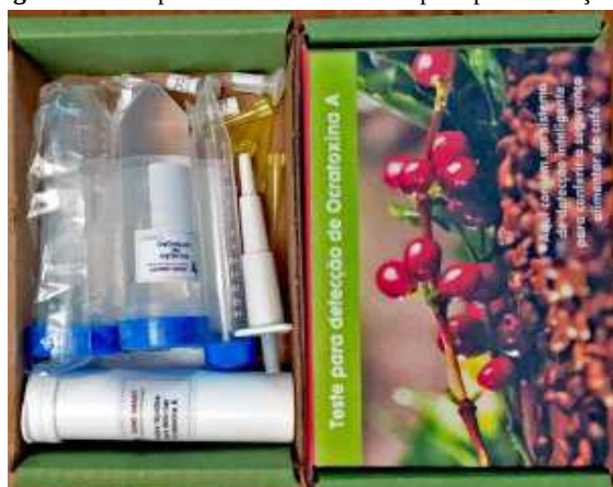
Esquerda: embalagem com os materiais e reagentes que compõem o kit para realizar a análise de OTA.
