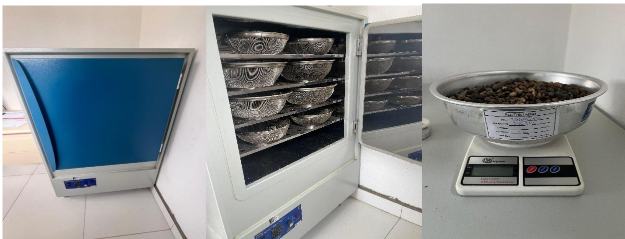
Imagem 2: Estufa de amostragem com sistema de circulação de ar e ferramentas de apoio.
