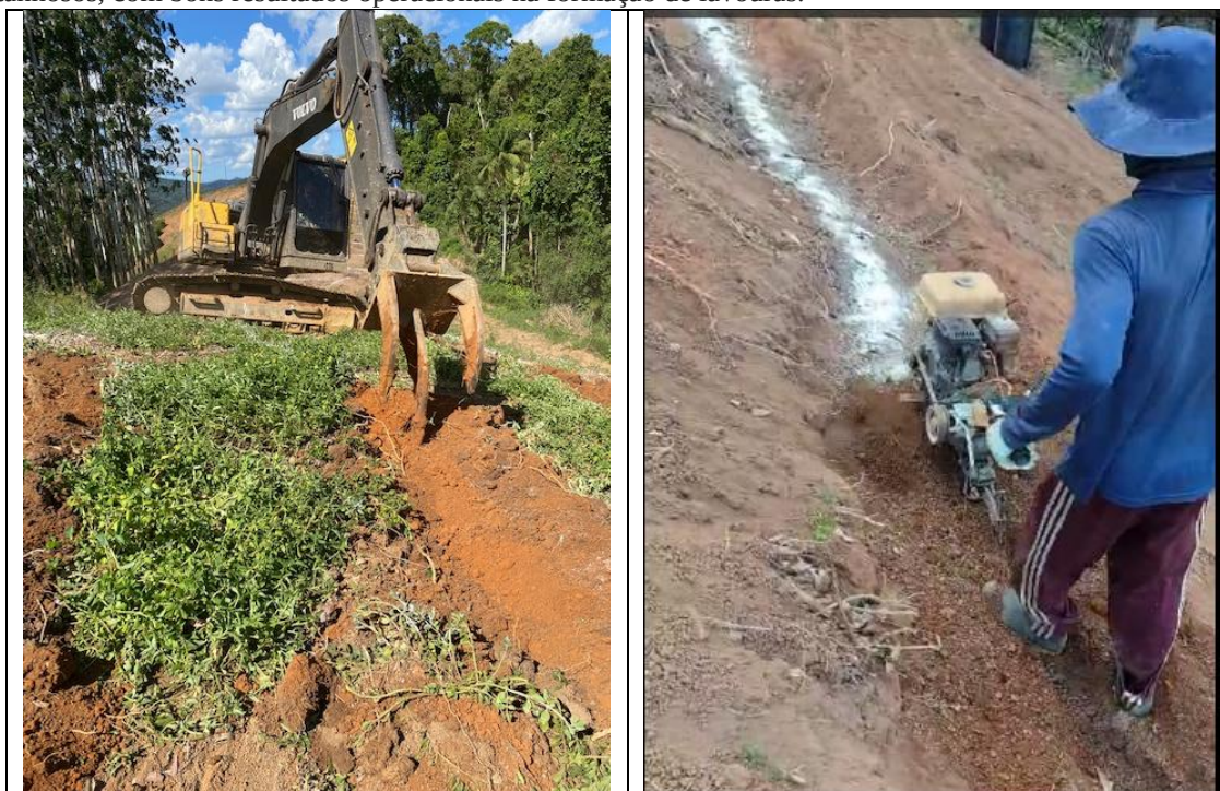
A escavadeira de esteira, com 3 garfos no lugar da concha, no movimento de abertura do sulco. Normalmente passa 2 vezes no mesmo local (esq.) e passando o tratorito sobre o calcário e adubos, distribuídos sobre o sulco, para sua mistura e incorporação na terra (dir.).
