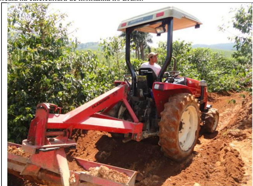
Trator estreito, traçado, com lamina traseira, abrindo terraço na entre linhas de cafeeiros, na região de Poços de Caldas-MG
