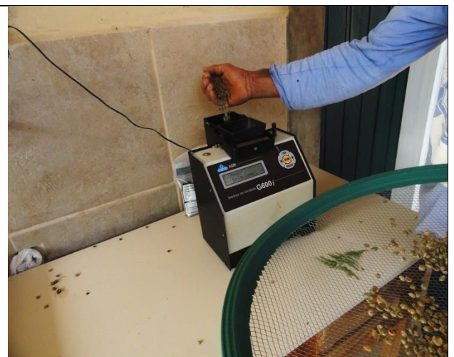
Grãos são pesados na balança em recipiente proprio do aparelho determinador de umidade, no caso digital.
